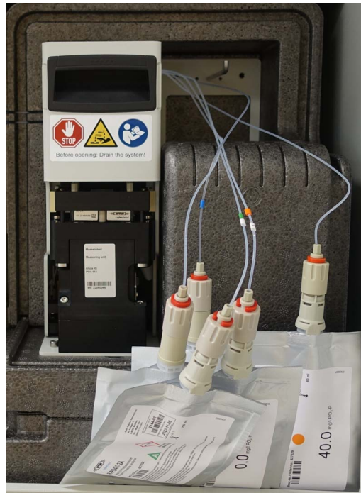
Bild 6-6 ChemBags für den Austausch entnommen
