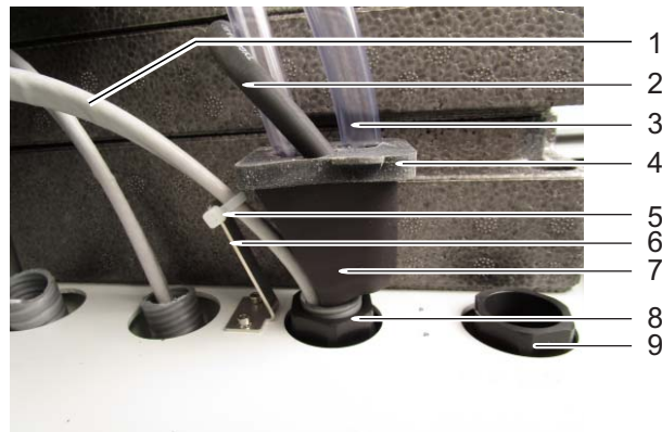
Bild 4-25 Sammeltrichter für die gemeinsame Entsorgung aller Flüssigkeiten (Ansicht von der Seite)
