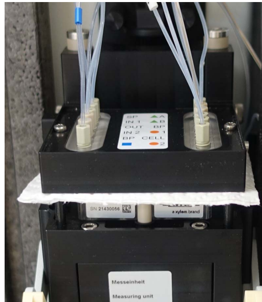
Bild 6-2 Entfernung von Flüssigkeitsresten mit saugfähigem, fusselfreiem Papier
