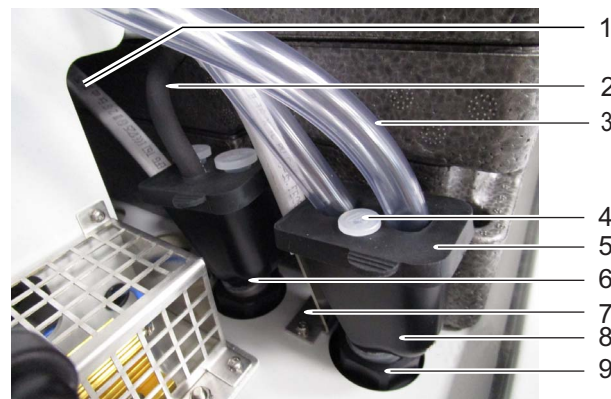
Bild 4-26 Sammeltrichter für die getrennte Entsorgung von Flüssigkeiten
