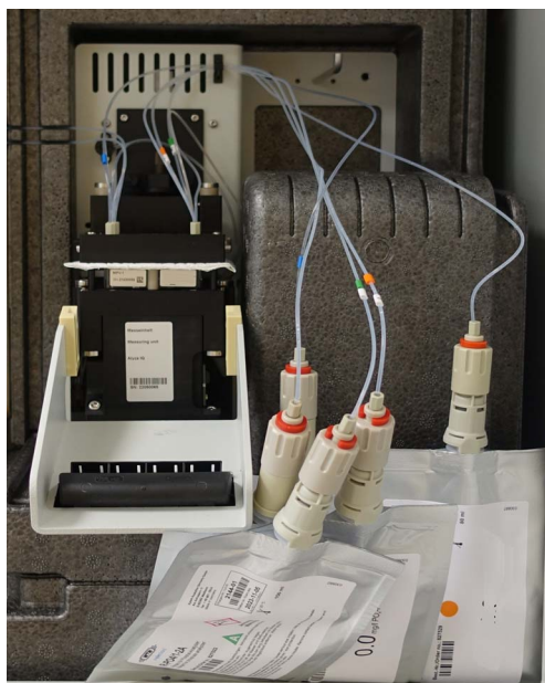
Bild 6-20 Saugfähiges Papier in der Aufnahme des MultiPort Ventils
