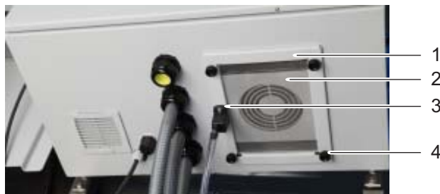
Bild 4-18 Montierter Insektenschutz und Kondensatablaufadapter
