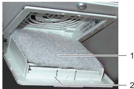
Bild 6-16 Untere Filtermatte wechseln
