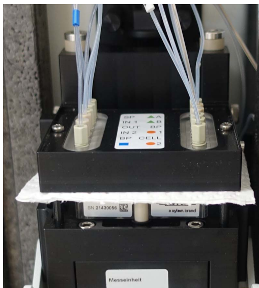
Bild 6-5 Entfernung von Flüssigkeitsresten mit saugfähigem, fusselfreiem Papier
